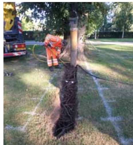
Het maken van de validatiesleuven tijdens de grondradarproef in Utrecht.
